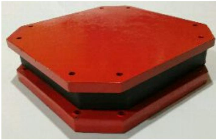
*Los aisladores sísmicos cónicos de fricción son dispositivos que se colocan en la base de edificios, puentes y en diversos equipos, que desacoplan el movimiento de los terremotos con la estructura, reduciendo considerablemente la fuerzas sísmicas al disminuir el coeficiente de fricción en los apoyos deslizantes.*
